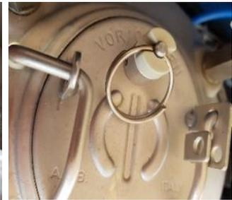
Refermez correctement le couvercle du réservoir Veillez que la soupape soit bien en place
