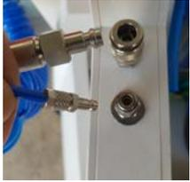
Branchement tuyau spirale double bleu et noir avec détrompeur
